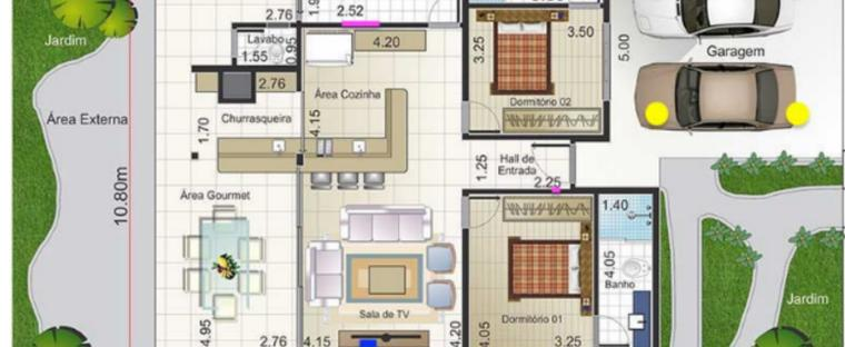
A iluminação da garagem, neste exemplo, é acionada tanto de forma sem fio quanto através de um interruptor comum. A caixa de passagem para o relay e para o interruptor comum localizam-se no hall de entrada. As lâmpadas da iluminação da garagem estão representadas em amarelo.
