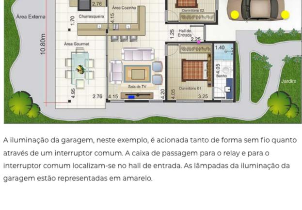
A iluminação da garagem, neste exemplo, é acionada tanto de forma sem fio quanto através de um interruptor comum. A caixa de passagem para o relay e para o interruptor comum localizam-se no hall de entrada. As lâmpadas da iluminação da garagem estão representadas em amarelo.
